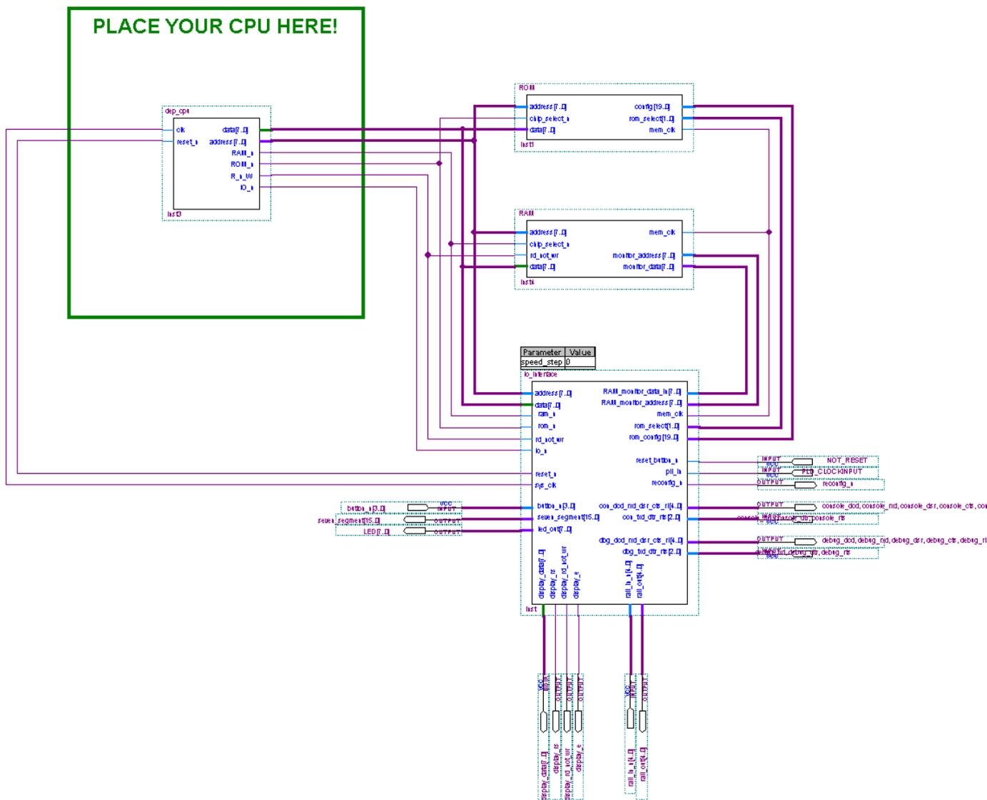
Abbildung 1: DEP-CPU-Vorlage mit bereits eingebauter CPU
